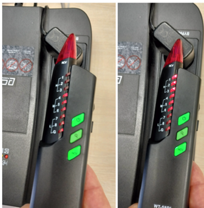
Рисунок 12 – Бесконтактное определение наличия напряжения
