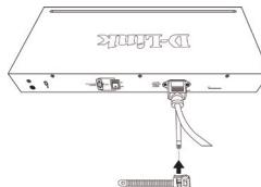
4. Оберните ленту зажима вокруг кабеля питания и вставьте ее в фиксирующий замок.
