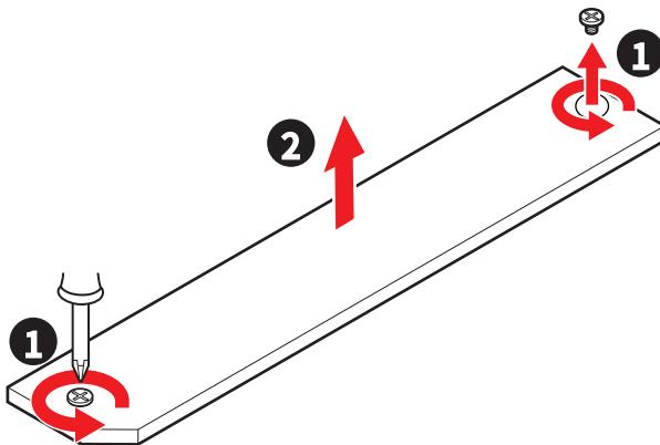
3. Для установки накопителя 22110 SSD в разъем M2\_1 используйте **инструмент для снятия зажима EZ M.2 II**, чтобы выкрутить **зажим EZ M.2 II** из отверстия под винт 2280. Пропустите этот шаг при установке 2280 SSD.
