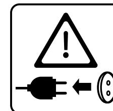
При обслуживании или ремонте отсоедините провод от электрической сети
