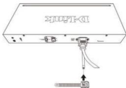
Рисунок 3-3. Установка зажима на стяжку
