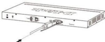
Рисунок 3-2. Подключение кабеля питания к коммутатору
