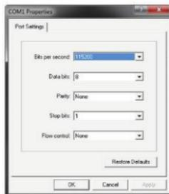
Рисунок 10. Свойства соединения в программе Hyperterminal
