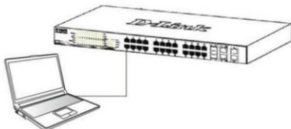
Рисунок 7. Подключение Ethernet-кабеля
