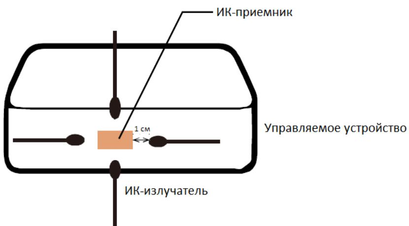
Пример 2: Также можно поместить инфракрасный излучатель перед окошком инфракрасного приемника на управляемом устройстве.
