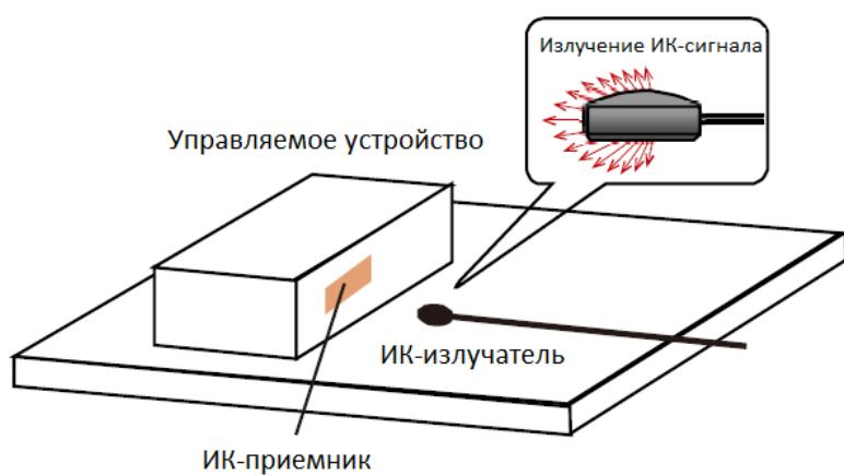
Пример 3: При подключении к системе управления убедитесь, что инфракрасный излучатель находится напротив передней стороны инфракрасного приемника, а не его ровной стороны (смотрите рисунки ниже):
