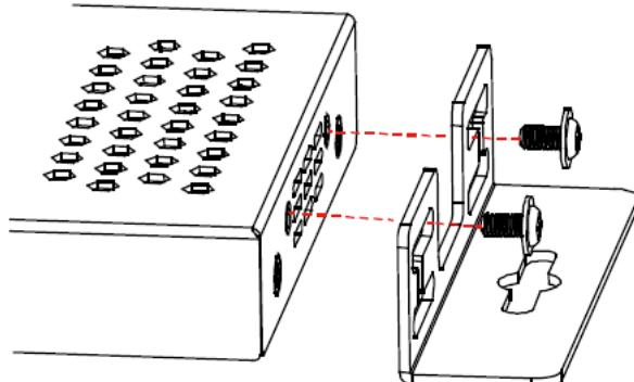
3. Повторите шаги 1 и 2 для закрепления кронштейна с другой стороны устройства.
