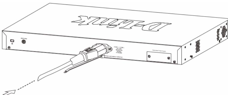
**Рисунок 6 — Подключение кабеля питания к коммутатору**
