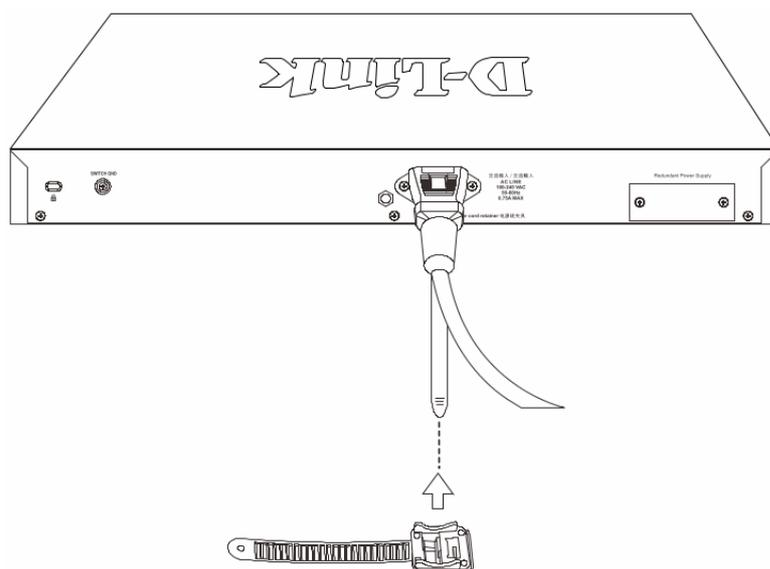
**Рисунок 7 — Установка зажима на стяжку**
