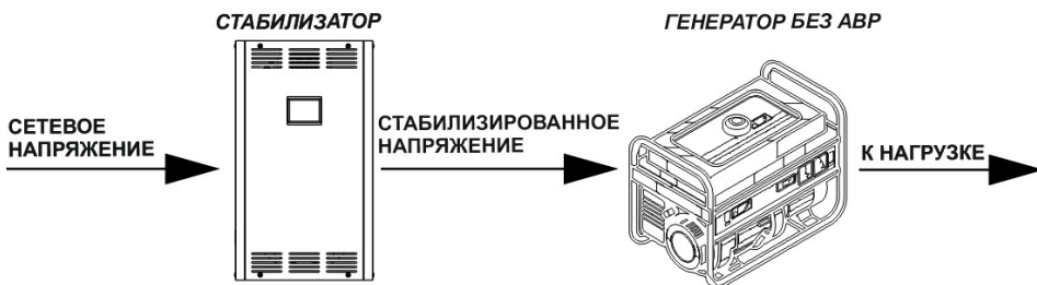
Рисунок 8 - Конфигурация 2 (размещение стабилизатора перед генератором)
