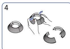
Disassemble the COVER-REAR TOP.
