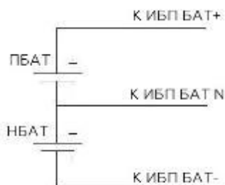
Схема подключения проводов аккумулятора
