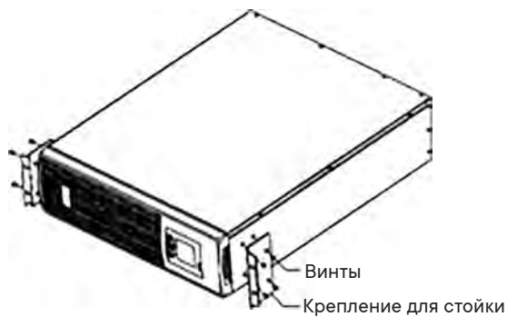
Рис. 6. Монтаж кронштейнов для установки в стойку
