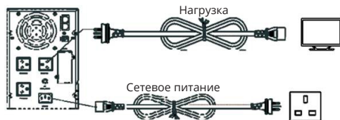
Рисунок 8-2. Подключение ИБП мощностью 1000-3000 кВА
