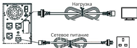
Рисунок 8-2. Подключение ИБП мощностью 1000-3000 кВА
