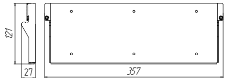
Рисунок 5. Внешний вид и габаритные размеры кронштейна для крепления ИБП Штиль SW500L, SW500SL, SW1000L и SW1000SL
