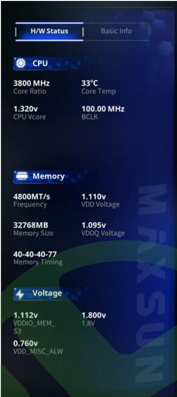
[硬件状态] 模块中，可实时显示当前主板的 CPU、内存、电压 等重要信息，包括频率、温度、内存时序和各种电压等。
