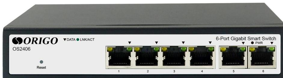
OS2406 – настраиваемый L2-коммутатор с 6 гигабитными портами RJ-45.
