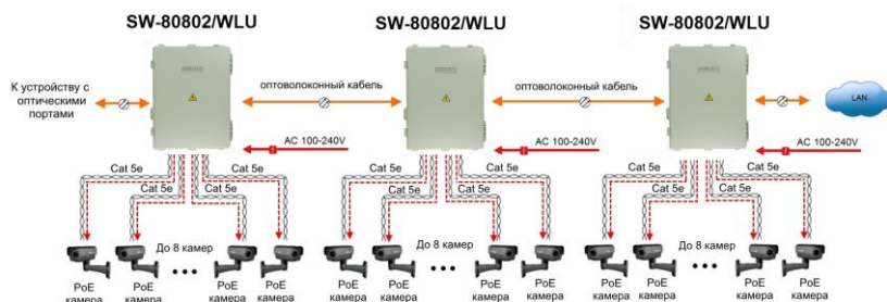
Рис.7 Каскадная схема подключения уличного коммутатора SW-80802/WLU
