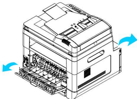
2. Откиньте вниз выходную направляющую узла термозакрепления.
