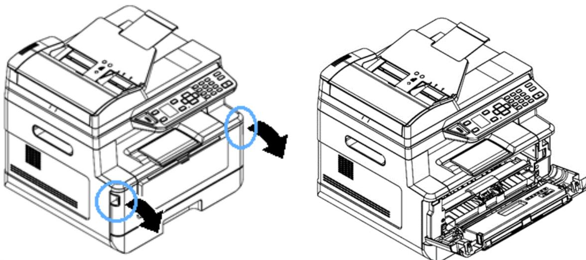
**4** Возьмитесь за ручку картриджа с барабаном (драм-картриджа), приподнимите ее (1), потяните на себя (2) и вытащите картридж, как показано на рисунке.
