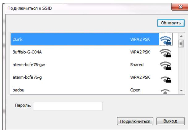
**6** Нажмите [Подключиться], чтобы начать подключение SSID (беспроводной сети), а затем обновите информацию об IP-адресе устройства.
