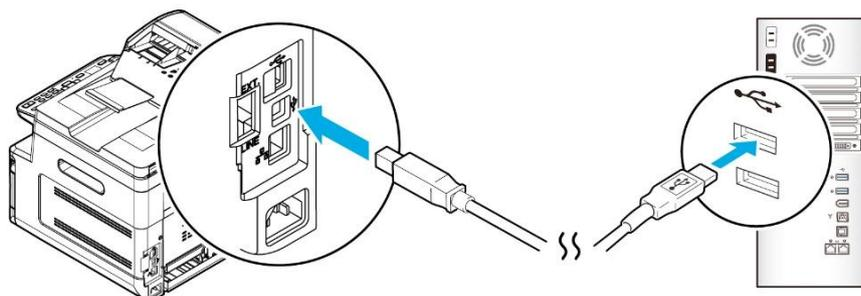
**6** После подключения МФУ к компьютеру по USB-кабелю нажмите кнопку [Далее >] и следуйте инструкциям на экране, чтобы завершить установку.
