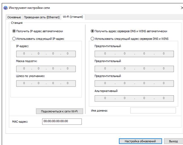
**4** Установите флажок [Получить IP-адрес автоматически], чтобы автоматически получить IP-адрес непосредственно с DHCP-сервера, или вы можете ввести свой статический IP-адрес в поля [IP-адрес], [Маска подсети] и [Шлюз по умолчанию] соответственно.
