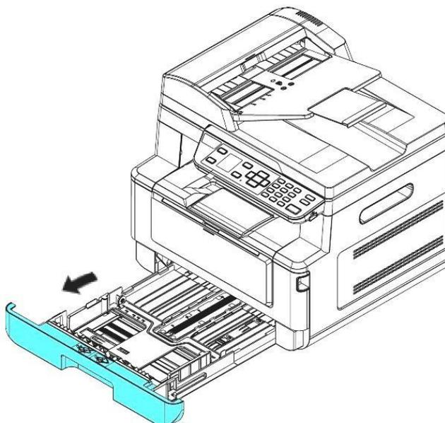
**4** Нажмите на фиксатор (1) ограничителя ширины (2), а затем переместите ограничитель ширины (2) в положение, соответствующее формату загружаемой бумаги.
