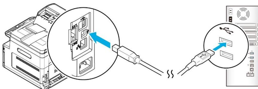
**8** После подключения МФУ к компьютеру по USB-кабелю нажмите кнопку [Далее >] и следуйте инструкциям на экране, чтобы завершить установку.
