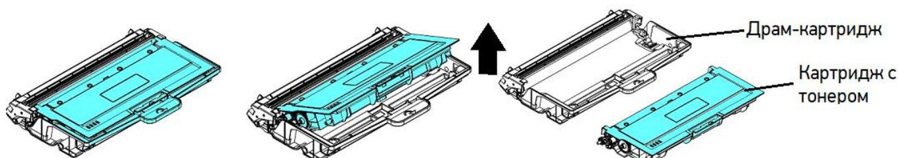
**5** Протрите поверхность фотобарабана чистой и мягкой тканью.
