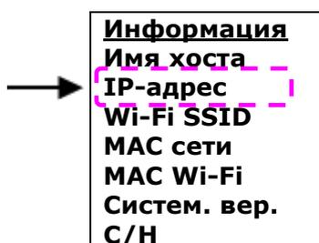
**4** С помощью клавиши **【▼】** выберите параметр [IP-адрес] и нажмите кнопку **[OK]**. Отобразится запрошенный с DHCP-сервера IP-адрес.
