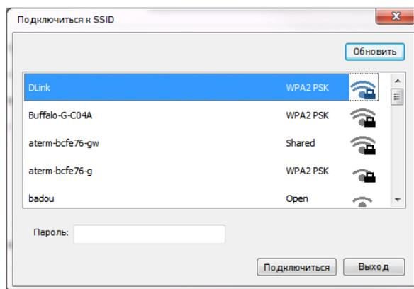
**6** Нажмите [Подключиться], чтобы начать подключение к выбранной сети, а затем обновите информацию об IP-адресе устройства.
