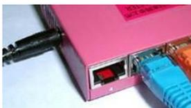
**2** Подключите другой конец сетевого кабеля к порту [LAN] на задней панели устройства, как показано на рисунке.
