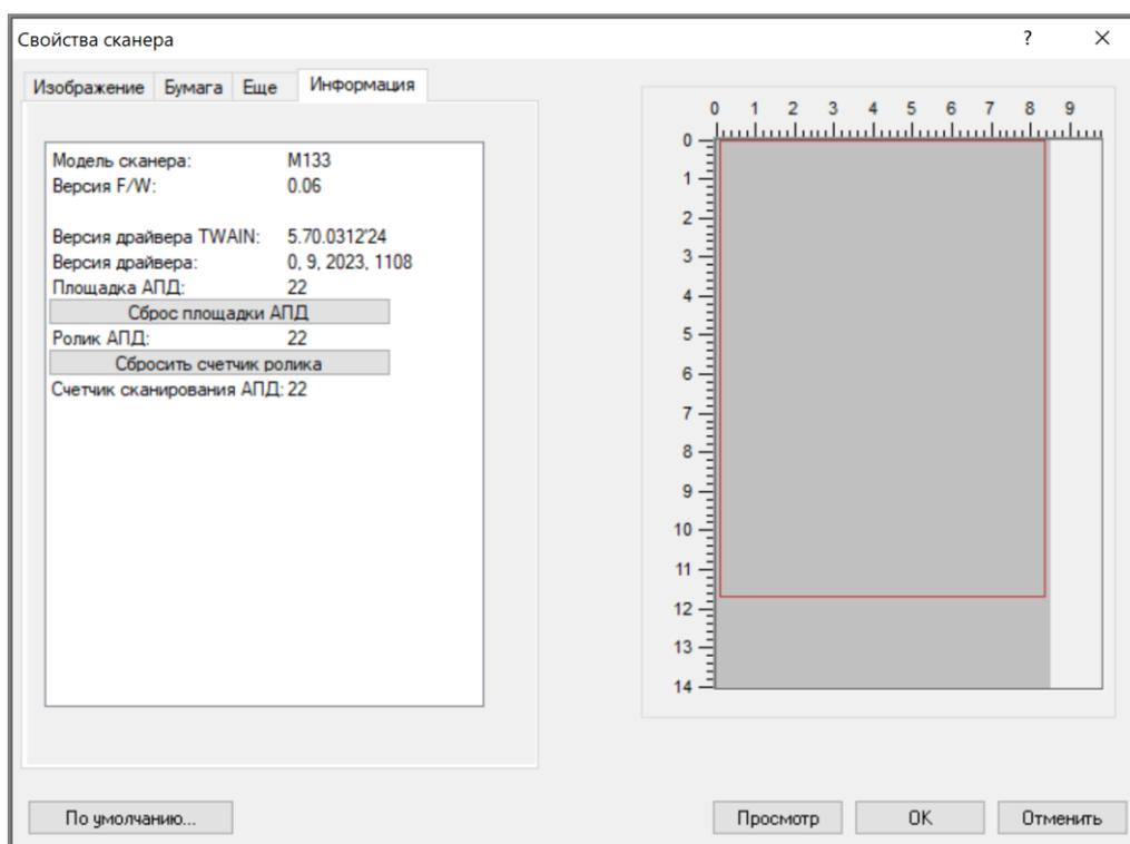
Во вкладке отображается информация о модели сканера, версиях программного обеспечения и драйверов, а также счетчики разделительной площадки и подающего ролика автоподатчика документов (АПД).
