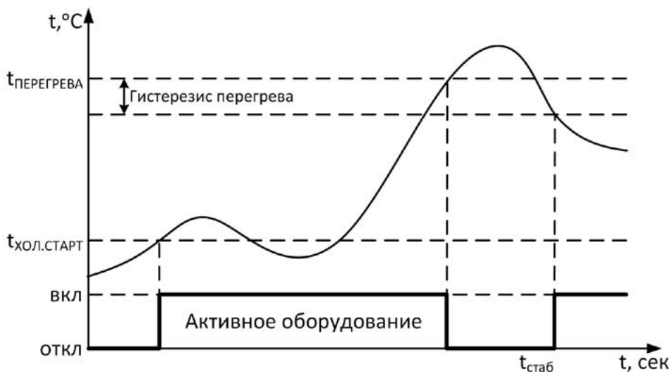
Рис. 6. Управление активным оборудованием
