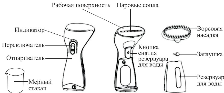
Отпариватель оснащен помпой (водяным насосом). Вода из резервуара подкачивается помпой и по шлангу передается к бойлеру, где испаряется. Пар выходит через паровые сопла на рабочей поверхности. Помпа позволяет точно дозировать количество подаваемой в бойлер воды и получать устойчивую подачу пара.
