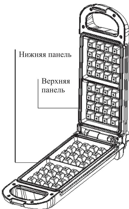
Индикатор питания загорается при включении вафельницы. Индикатор нагрева горит в то время, когда вафельница разогревается. Когда рабочие поверхности достигнут температуры, определяемой термостатом, нагрев выключится, и индикатор нагрева погаснет. Затем нагрев будет периодически включаться для поддержания температуры, в это время индикатор нагрева будет гореть. Таким образом, в процессе приготовления индикатор нагрева периодически загорается и гаснет.
