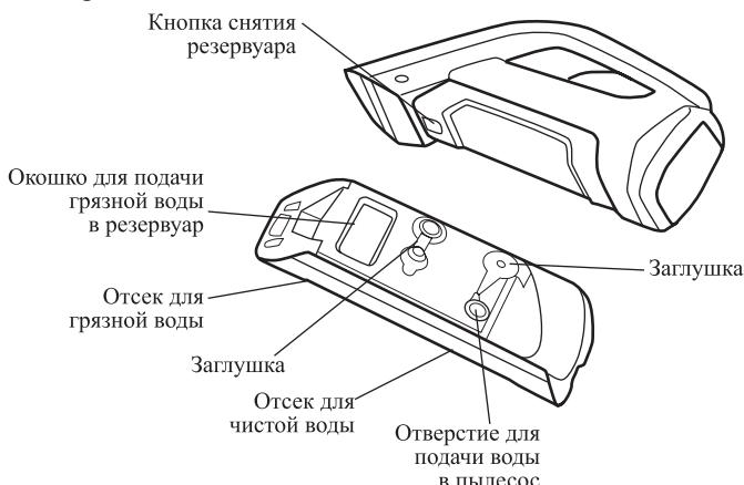
После использования пылесоса слейте из него грязную воду и чистую воду, если она осталась. Для этого снимите резервуар, откройте заглушки на отсеках для грязной и чистой воды над раковиной и слейте воду.
