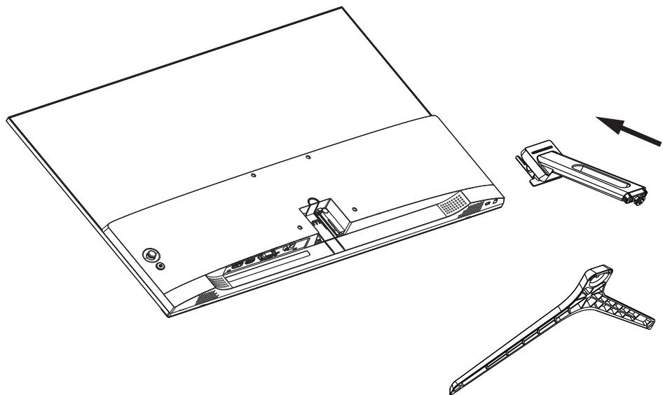
3. Установите собранный корпус подставки в пазы задней части монитора до характерного щелчка.
