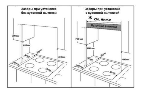
Минимальное расстояние до наклонной кухонной вытяжки — **650 мм**, до встраиваемой — **700 мм**.
