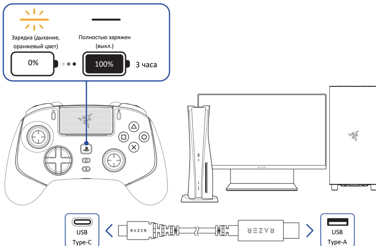
**i** Для зарядки геймпада Razer используйте только входящий в комплект поставки кабель USB Type-A/Type-C. Для наилучшего результата полностью зарядите геймпад, прежде чем использовать его в первый раз. Зарядка полностью разряженной батареи длится приблизительно 3 часа.
