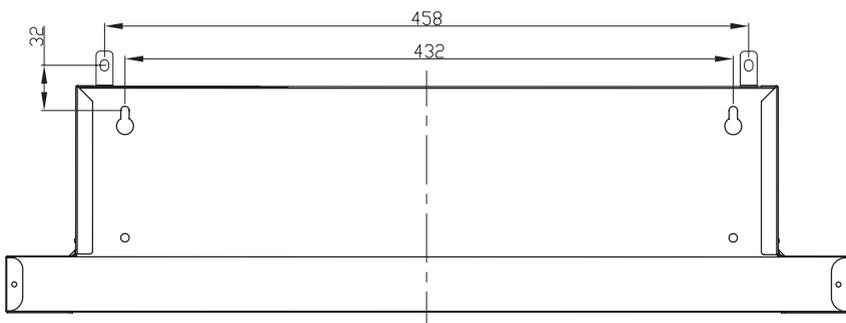
2. Установите **L-образные** кронштейны в верхней части корпуса с помощью **2 винтов (4x10 мм)**.
