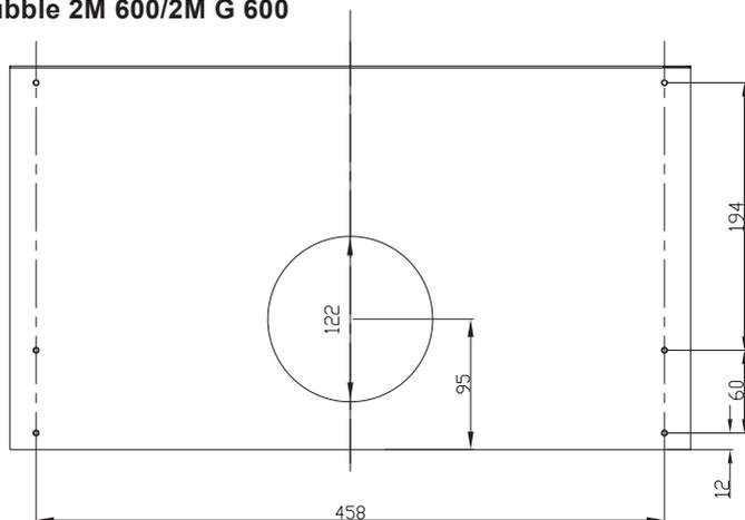
Убедитесь, что расстояние от края отверстия до края шкафа составляет **не менее 35 мм**. Наметьте и просверлите отверстия **диаметром 4 мм** для крепления вытяжки. Выполните отверстия для переходника и воздуховода.
