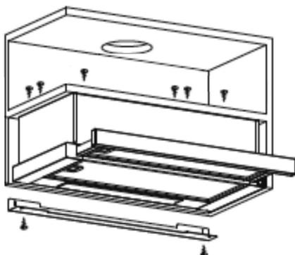
Если между стеной и вытяжкой имеется зазор, можно установить **L-образный** кронштейн в нижней части вытяжки двумя винтами (**3 x 12 мм**).
