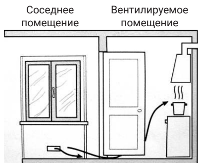
Рисунок 4. Вентиляция через соседнее помещение
