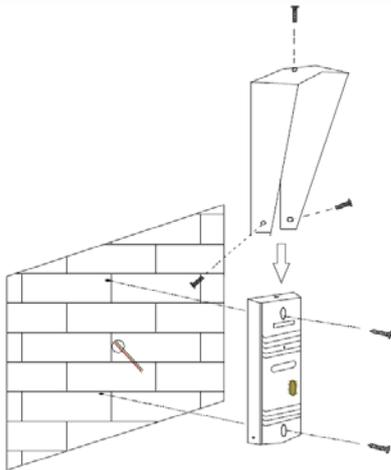
1. Просверлите в стене отверстия под кабели и крепеж панели на нужной высоте.
