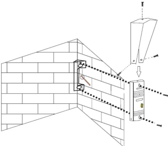
1. Просверлите в стене отверстия под кабели и крепеж углового кронштейна на нужной высоте.
