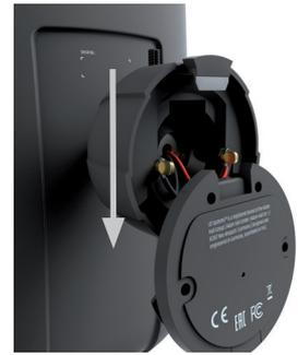
**2** Befestigen Sie die Wandmontageplatte mit dem Klemmblock nach oben zeigend mit Hilfe von geeignetem Befestigungsmaterial sicher an einer ausreichend tragfähigen Wand. Bei unter Putz verlegten Lautsprecherkabeln muss das entsprechende Kabel vor dem Befestigen der Wandmontageplatte durch die zentrale Kabeldurchführung gesteckt werden. Verbinden Sie nun die Lautsprecherkabel mit den entsprechenden Kontakten des Klemmblocks.
