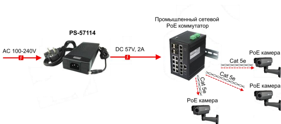
Рис.3 Типовая схема подключения блоков питания на примере PS-57114
