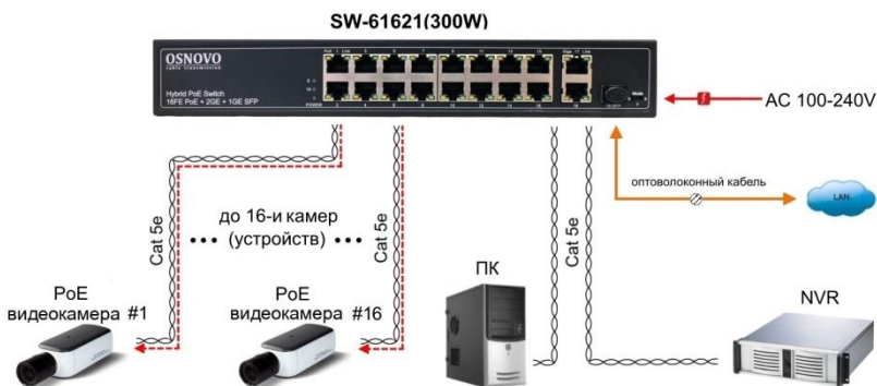
Рис.4 Типовая схема подключения коммутатора SW-61621(300W)
