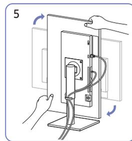
Поверните устройство в горизонтальное положение.
