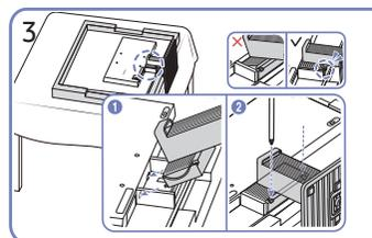
Постелите на стол мягкую ткань, а на нее экраном вниз положите устройство. Вставьте собранную подставку в корпус в направлении стрелки, как показано на рисунке. Полностью закрутите соединительный винт в центральной части подставки, чтобы как следует зафиксировать соединительный элемент.
