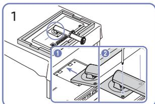
Вставьте соединительный элемент подставки в корпус в направлении стрелки, как показано на рисунке. Проверьте, надежно ли закреплен соединительный элемент подставки.
