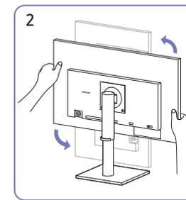
Поверните устройство в самое высокое вертикальное положение.
