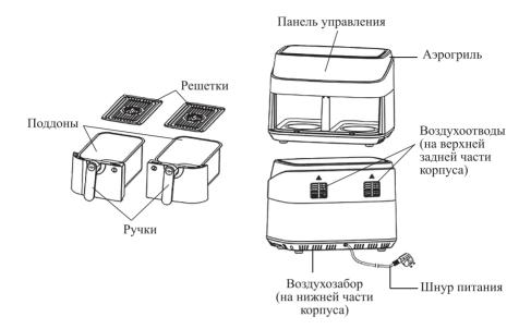
Принцип работы аэрогриля основан на конвекции воздушных потоков от нагревателей внутри рабочей емкости. Вентиляторы, расположенные в верхней части аэрогриля, приводят в движение воздушные массы, нагретые до высокой температуры ТЭНами (трубчатыми электронагревателями). Горячий воздух циркулирует внутри рабочей емкости аэрогриля и нагревает продукты до нужной температуры.
