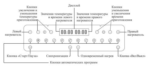
Кнопка «Вкл/Выкл» включает и выключает устройство.
