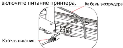
Примечание: При подключении кабеля питания, пожалуйста, избегайте пересечения с кабелем экструдера, чтобы предотвратить интерференцию.
