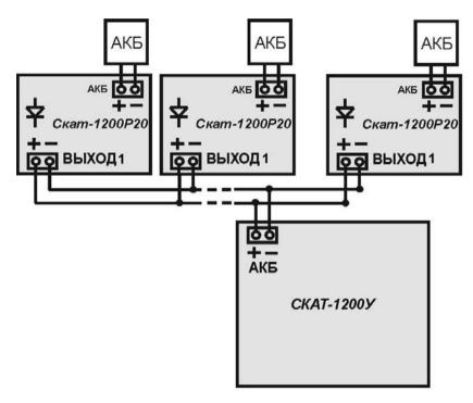
Схема каскадного подключения источника с целью увеличения длительности работы
