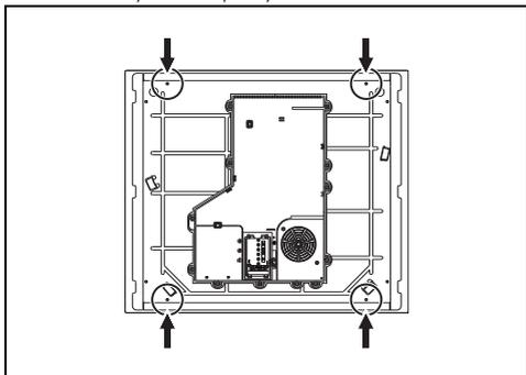
2. Для правильного крепления варочной панели к конструкции винтите крепежные кронштейны (А) в отверстия, намеченные ранее удаленными винтами.
