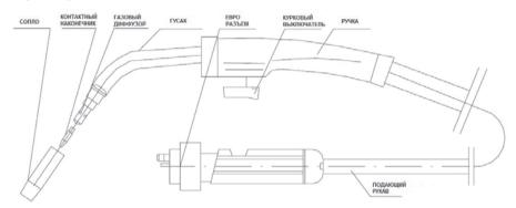
Горелка служит для подведения к месту сварки проволоки, газа и напряжения. Подключается к аппарату с помощью специального евро разъема (WMA 205 MQ, WMA 225 MQ) или используется жесткое соединение (WMA 175M).
