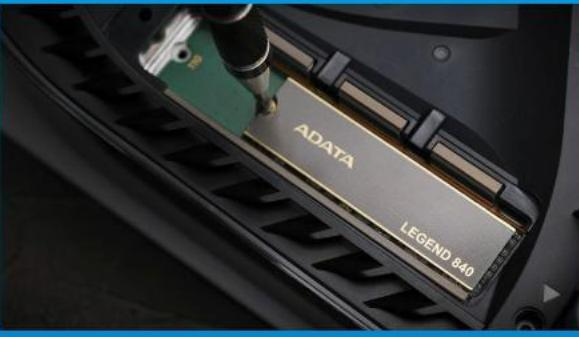
**9. FIXAȚI SSD-UL CU AJUTORUL ȘURUBULUI.**
