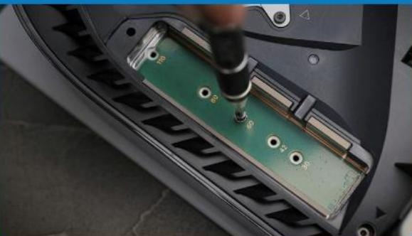
**6. RETIRE EL ÚNICO TORNILLO Y EL ESPACIADOR EN FORMA DE ARANDELA SITUADO DEBAJO.**
