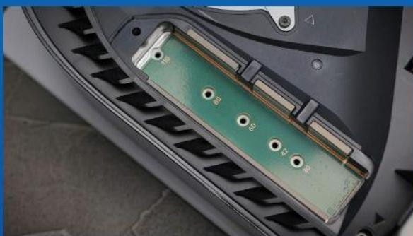
7. 将垫圈支架放入与M.2固态硬盘长度对应的孔洞中。
