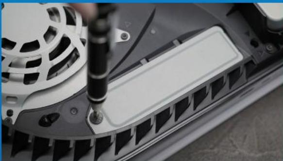
**10. MONTIEREN SIE DIE ABDECKUNG DES ERWEITERUNGSSTECKPLATZES WIEDER.**
