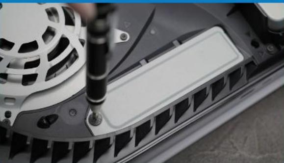
**10. REINSTALL THE EXPANSION SLOT COVER.**
