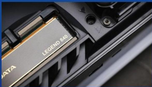
8. 將固態硬碟的金色連接器，插入相容的插槽中。
