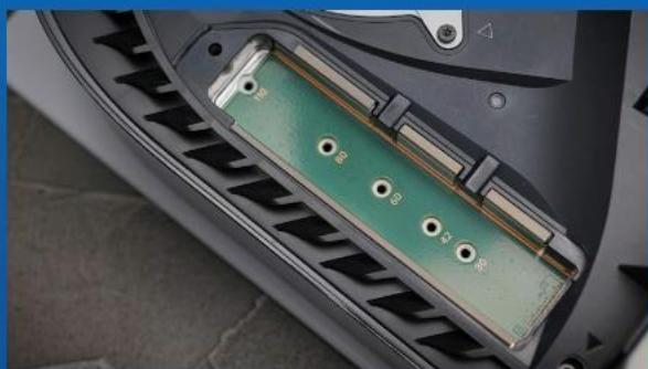
7. 將墊圈支架放入與M.2固態硬碟長度對應的孔洞中。
