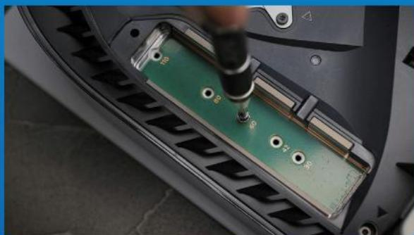
6. 拆除固定固態硬碟的螺絲和下方的墊圈支架。
