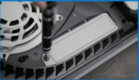
**10. RECOLOQUE A TAMPA DO SLOT DE EXPANSÃO.**
