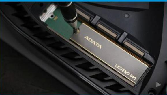
**9. BEFESTIGEN SIE DIE SSD MITHILFE DER SCHRAUBE.**
