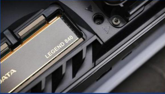
**8. ВСТАВЬТЕ ЗОЛОТОЙ РАЗЪЕМ ТВЕРДОТЕЛЬНОГО НАКОПИТЕЛЯ В СООТВЕТСТВУЮЩИЙ ПАЗ ДО ЩЕЛЧКА.**
