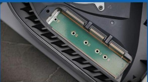
**7. COLOQUE O ESPAÇADOR NO ORIFÍCIO QUE CORRESPONDE AO FATOR DE FORMA M.2.**
