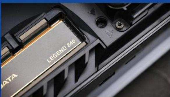
8. 将固态硬盘的金色连接器，插入相容的插槽中。
