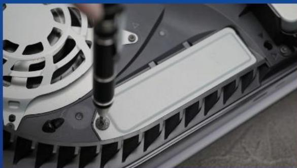
**4. ОТКРУТИТЕ ВИНТ, ЧТОБЫ СНЯТЬ КРЫШКУ СЛОТА РАСШИРЕНИЯ.**
