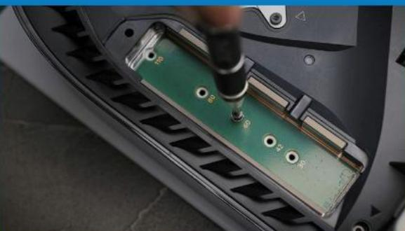
**6. ÎNDEPĂRTAȚI UN SINGUR ȘURUB ȘI DISTANȚIERUL DE TIP ȘAIBĂ DE DEDESUBT.**
