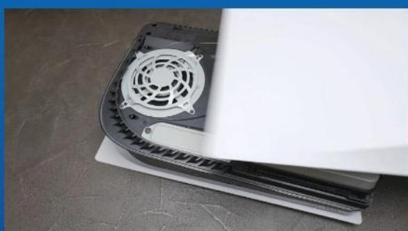
11. 通过向后滑动并下压，来重新安装PS5主机背板。
