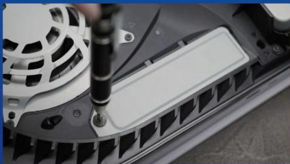
4. ネジを緩めて、拡張スロットのカバーを取り外します。
