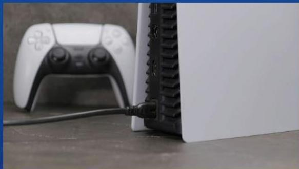
**3. 移除所有主机上的线材跟装置。**
