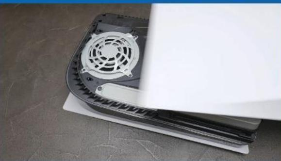
**11. REINSTALL THE BACKING PLATE BY SLIDING IT BACK AND PUSHING DOWNWARDS.**
