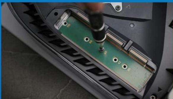
6. 拆除固定固态硬盘的螺丝和下方的垫圈支架。
