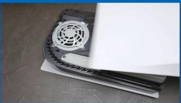
**11. RECOLOQUE A PLACA TRASEIRA DESLIZANDO-A PARA TRÁS E EMPURRANDO PARA BAIXO.**
