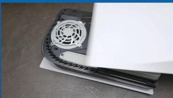
**11. MONTIEREN SIE DIE STÜTZPLATTE WIEDER, INDEM SIE SIE ZURÜCKSCHIEBEN UND NACH UNTEN DRÜCKEN.**
