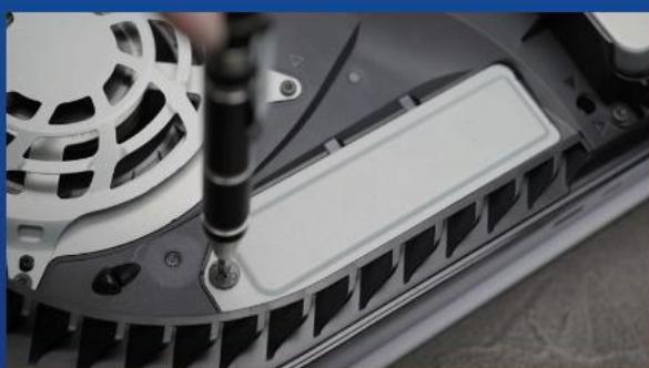
**4. AFLOJE EL TORNILLO PARA RETIRAR LA TAPA DE LA RANURA DE EXPANSIÓN.**
