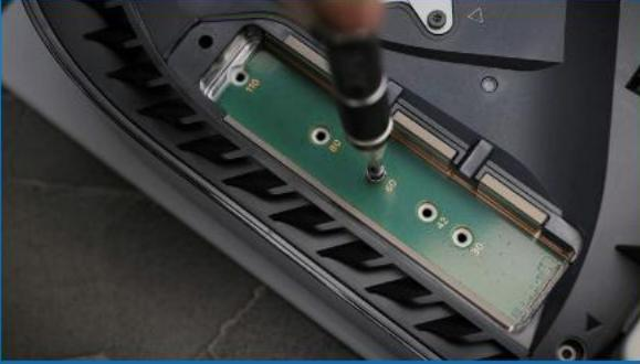
**6. ИЗВЛЕКИТЕ ОДИН ВИНТ И РАСПОЛОЖЕННУЮ ПОД НИМ СТОЙКУ-РАЗДЕЛИТЕЛЬ.**
