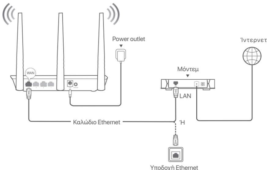
(Το F3 που χρησιμοποιείται ως παράδειγμα. Η καλωδίωση και των άλλων μοντέλων είναι παρόμοια, ανεξάρτητα από την εμφάνισή τους.)
