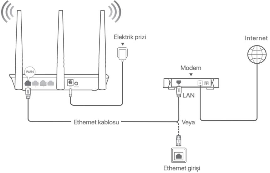
(Örneğin F3 kullanılır. Diğer modellerin kablo bağlantıları görünülerinden bağımsız olarak benzerdir)
