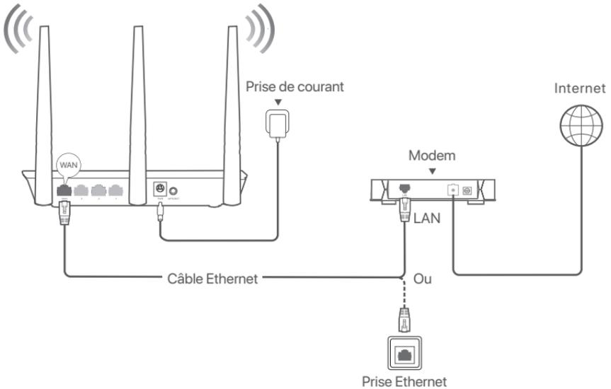
(F3 utilisé par exemple. Le câblage des autres modèles est similaire quelle que soit leur apparence.)
