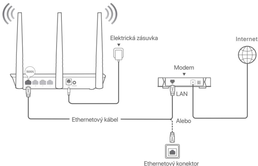
(napríklad F3. Pripojenie pre ostatné modely je podobné, bez ohľadu na ich vzhľad.)
