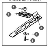
Рис. 14 Схема крепления ножа
