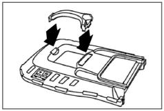
Рис. 5 Установка ручки травосборника
