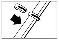
Рис. 4 Крепления кабеля включения
