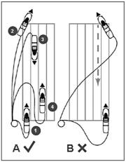
Рис. 12 Положение кабеля при кошении
