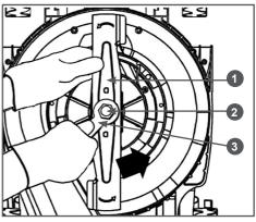
**Рис. 13 Замена ножа** 1. Нож 2. Болт 3. Ключ
