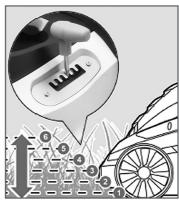
Рис. 8 Регулировка высоты кошения
