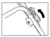
Рис. 2 Соединение верхней и нижней части рукоятки
